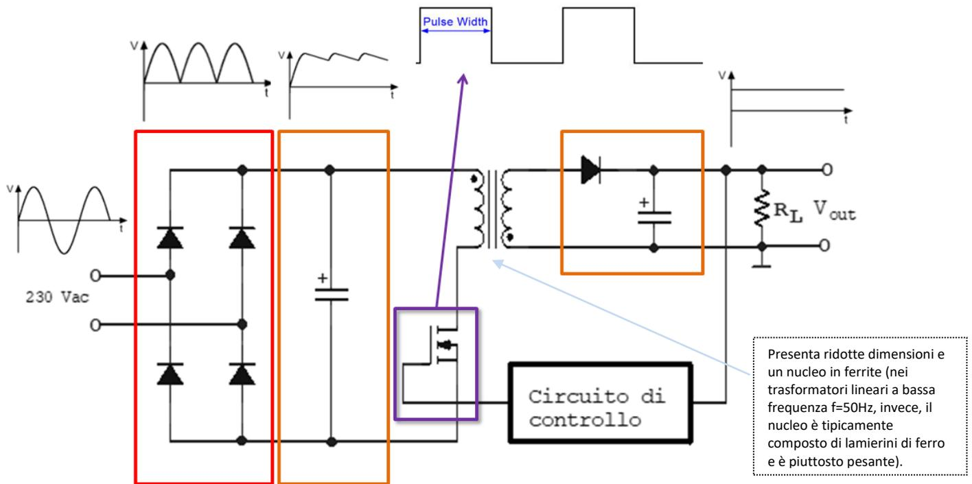
L'onda quadra in uscita dall'inverter viene ulteriormente raddrizzata da un diodo e filtrata (blocco raddrizzatore e filtro d'uscita); si noti che il filtro è di tipo LC, dato che il segnale da filtrare è ad alta frequenza.
