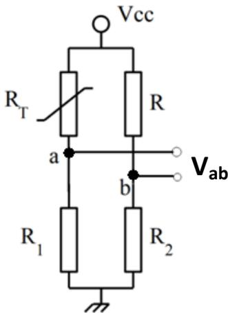
$V_{cc} = V_{in}$  rappresenta la tensione di alimentazione del ponte (es. 5V, 12V).
