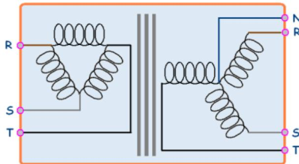
Grazie alla presenza di questo quarto conduttore, è possibile ricavare dal sistema trifase anche delle tensioni alternate monofase del valore di 220V, che rappresentano la tensione comunemente presente nelle nostre case.
