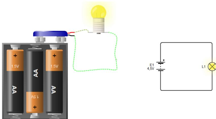
La pila è il generatore del circuito con una tensione di 4,5 V, il circuito è chiuso, in esso circola una corrente di 0,10 A e la nostra incognita è il valore della resistenza R della lampadina:
