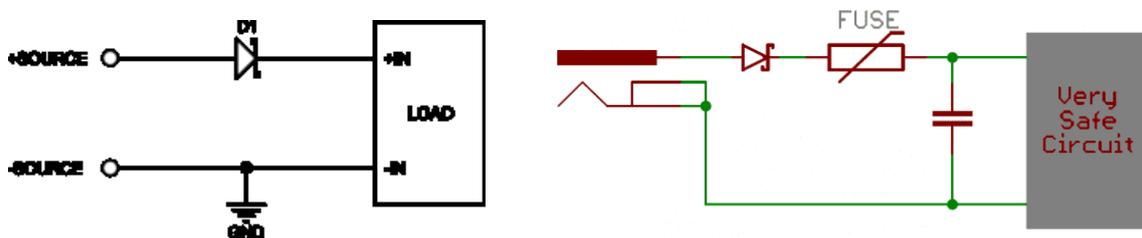
La presenza del fusibile garantisce la protezione del diodo che se sottoposto a tensione negativa per molto tempo si brucerebbe.
