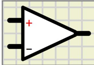
La tensione in uscita alta ha lo stesso valore dell'alimentazione del circuito comparatore (tipicamente 12-24V).
