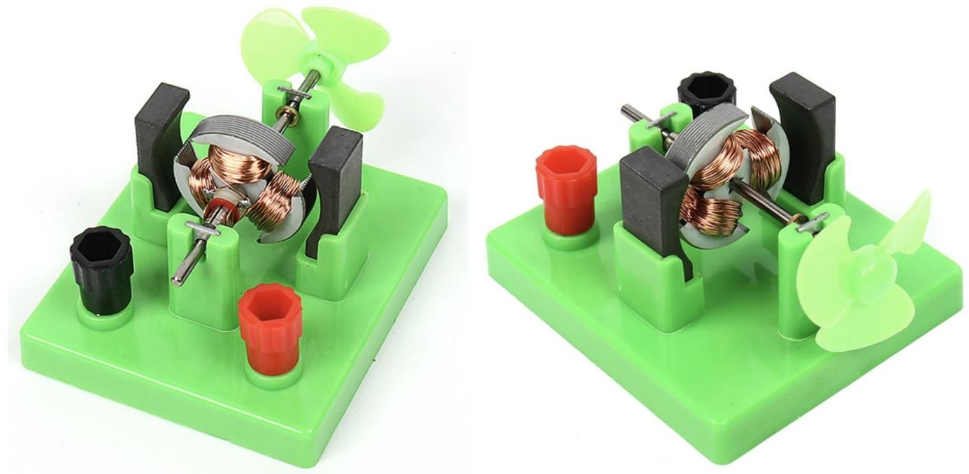
Collegare un alimentatore da laboratorio ai morsetti + e - e un amperometro per controllare la corrente assorbita.
