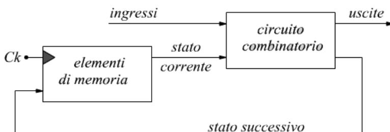
Come per le reti combinatorie, esistono delle procedure di sintesi anche per i circuiti sequenziali sincroni.
