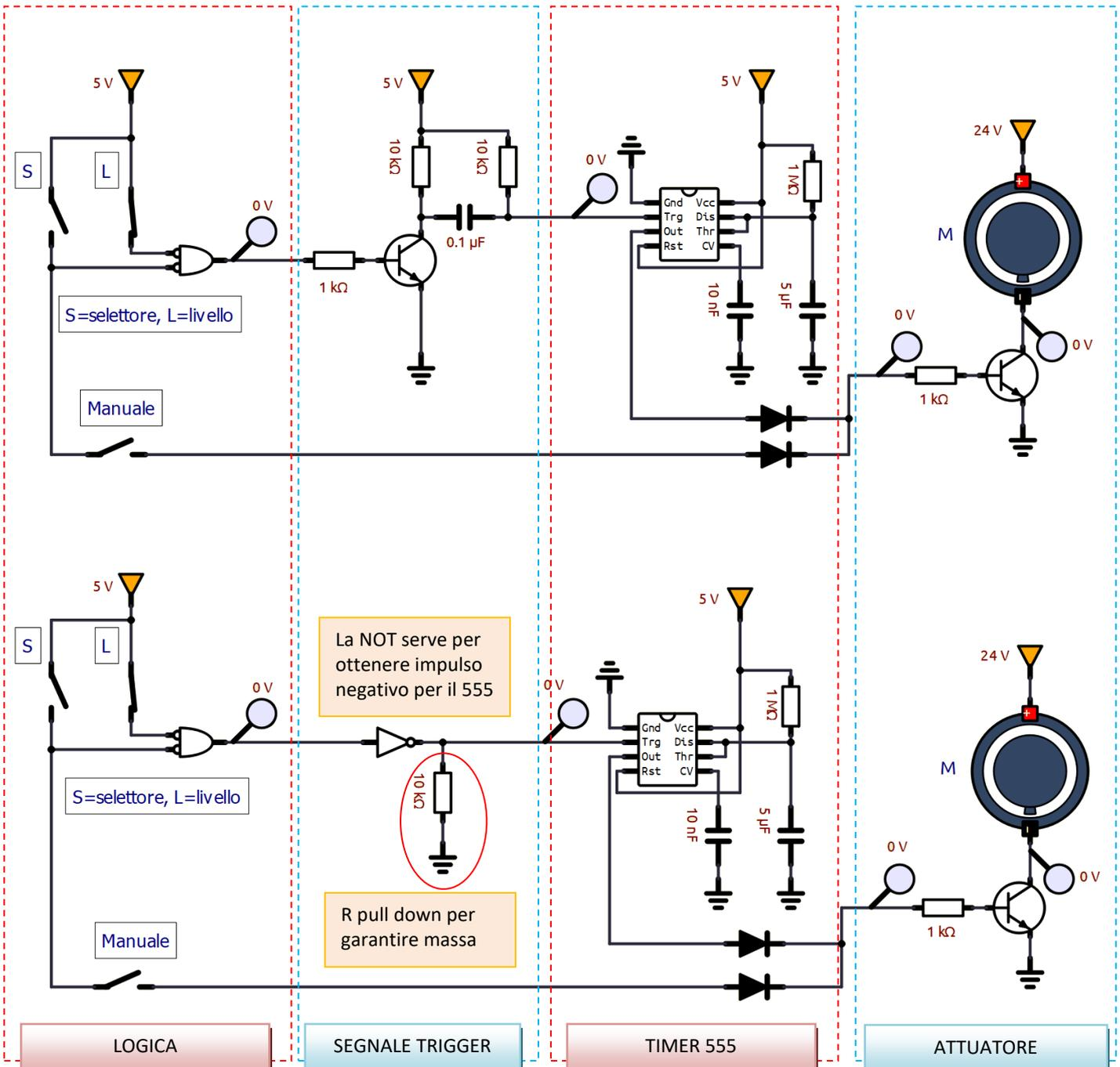
L'interruttore manuale M permette di avviare la pompa quando il selettore è in modalità manuale.
