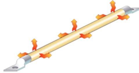
Quando un conduttore trasporta energia elettrica gran parte dell'energia viene convertita in calore per **effetto Joule**, il calore si disperde nell'ambiente circostante per convezione e irraggiamento.
