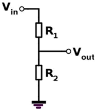
A  $0^\circ\text{C}$  la tensione in uscita la partitore vale 2,5V ( $R_s=R_2=10K$ ).
