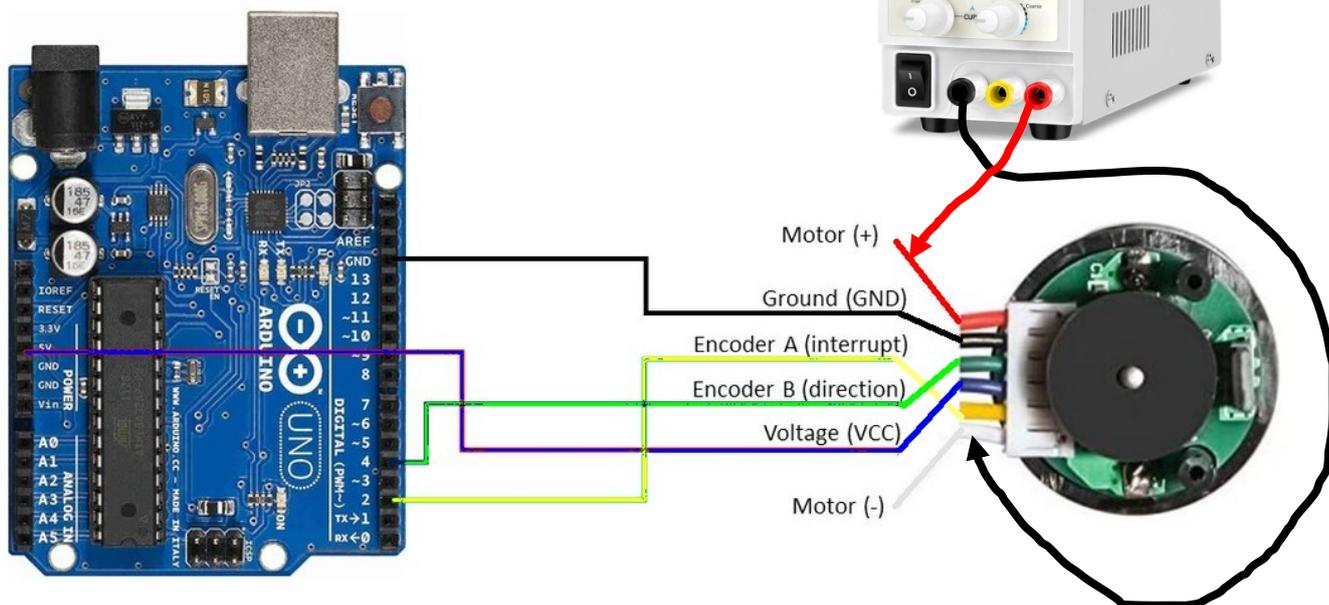
Utilizzare un alimentatore da laboratorio per alimentare il motore (M+ e M-) facendo variare la tensione con passo 1 V. Leggere la corrente assorbita dal motore direttamente dall'alimentatore.
