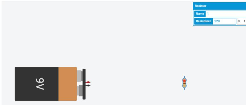
Per collegare i componenti è sufficiente posizionare il cursore sull'estremità di un componente (apparirà un quadrato rosso) e tenere premuto il tasto sinistro del mouse; trascinare fino all'estremità del componente da collegare e rilasciare il tasto sinistro del mouse.
