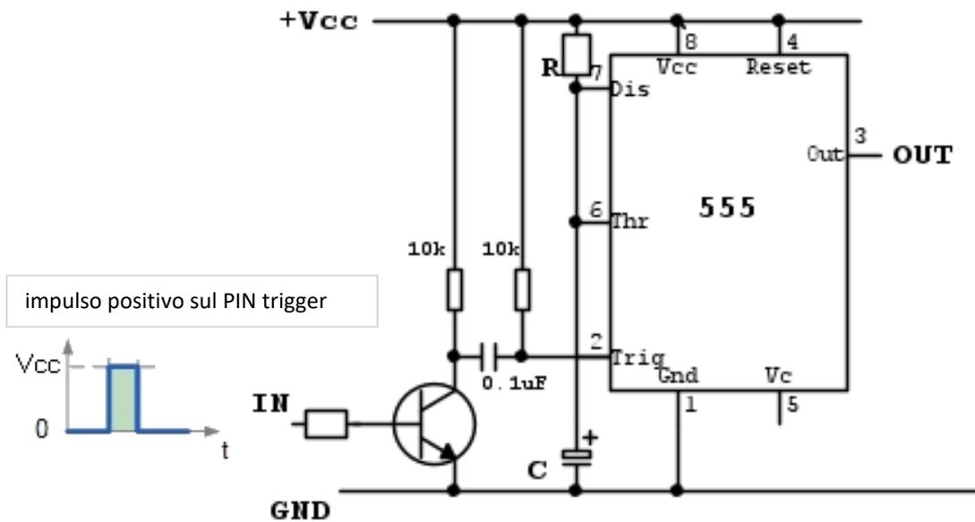
Circuito in Simulide con temporizzazione di 5,5 secondi.
