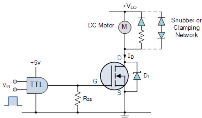
Poiché il carico del motore è induttivo, un diodo di protezione va collegato in parallelo al motore per dissipare l'eventuale f.e.m. generata dal motore quando il MOSFET lo spegne.
