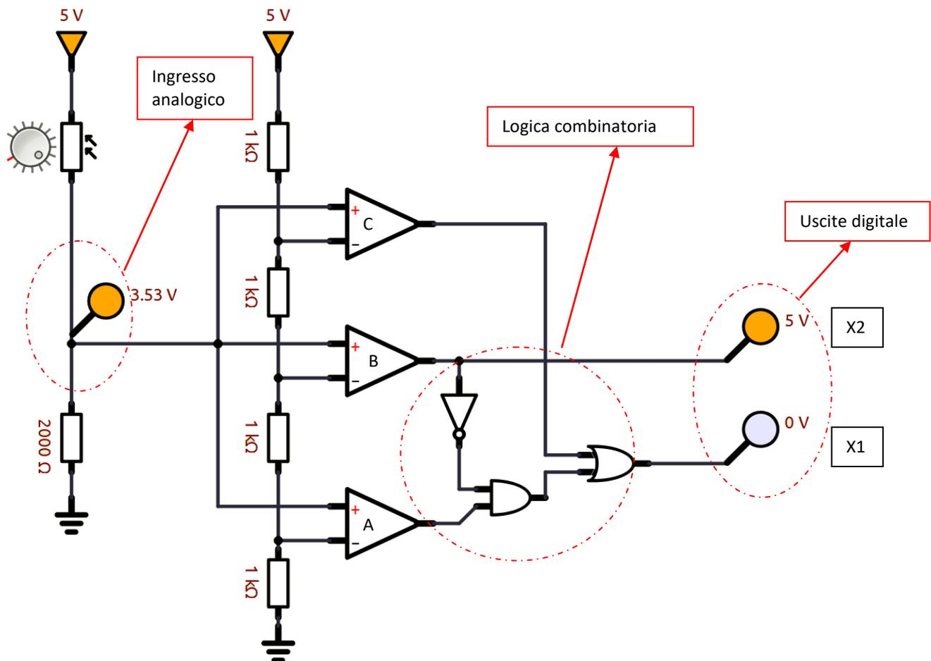
Il partitore multiplo (costituito da 4 resistenze da 1K) crea tre livelli di tensione in ingresso ai 3 comparatori. Quando la tensione in uscita al sensore supera questi livelli l'uscita del comparatore corrispondente va alta. La rete logica fa in modo che le 8 possibili combinazioni di A,B,C vengano ridotte a sole 4 combinazioni digitali.
