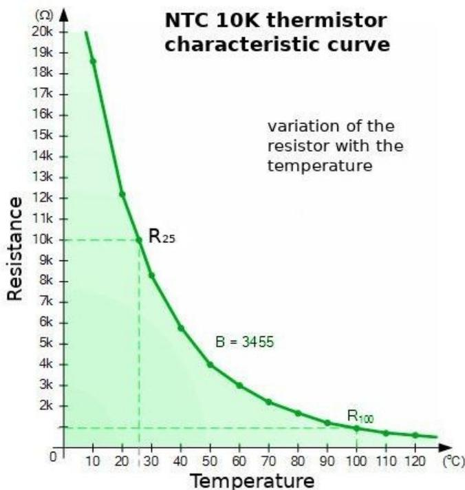
Accettando un piccolo errore si usa l'equazione semplificata basata solo sul parametro B che fornisce la T in kelvin:
