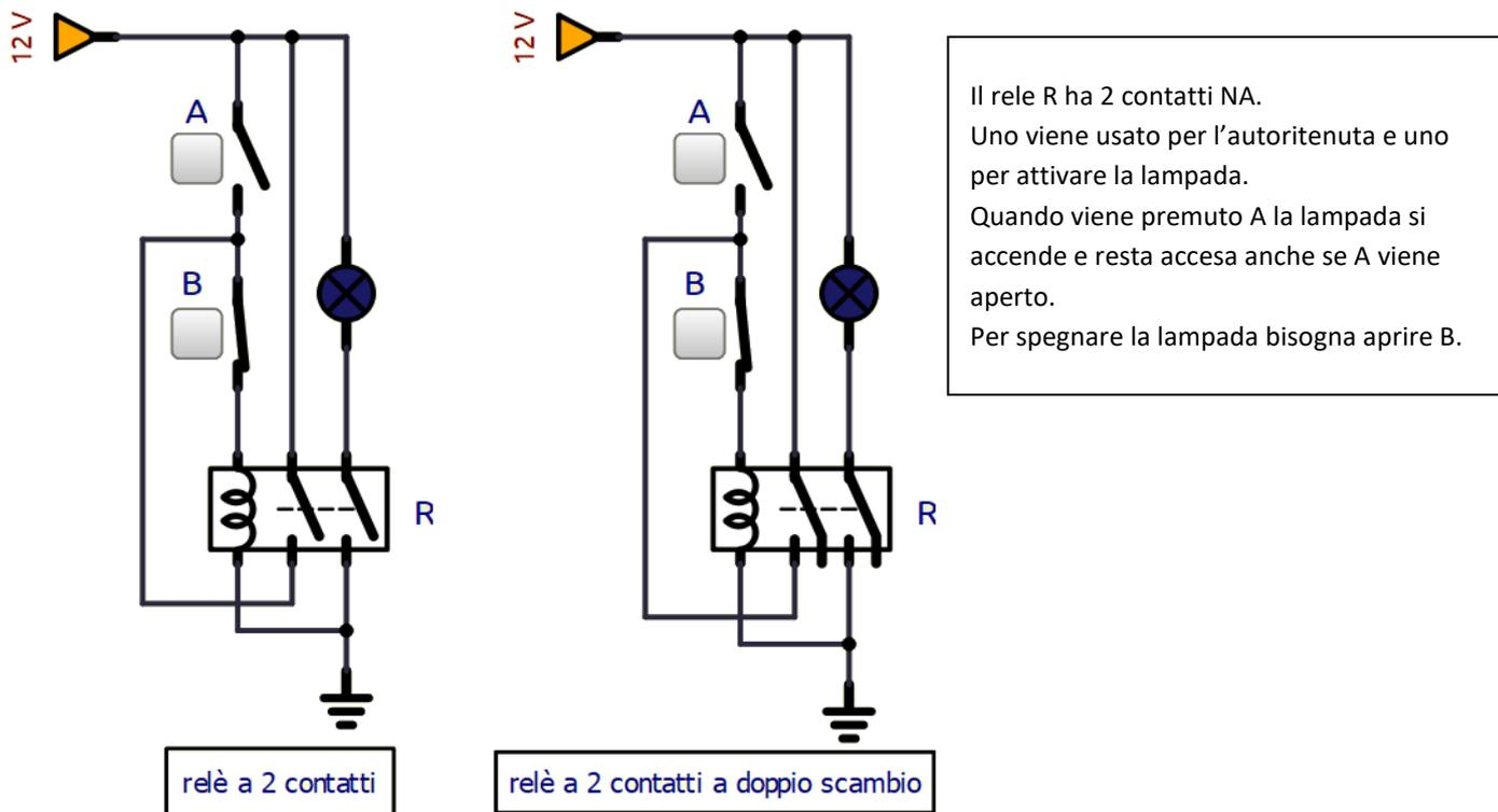
Il rele R ha 2 contatti NA. Uno viene usato per l'autoritenuta e uno per attivare la lampada. Quando si chiude A la lampada si accende e resta accesa anche se A viene aperto. Per spegnere la lampada bisogna aprire B.
