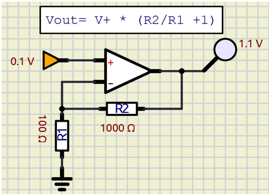
Esempio amplificazione segnale da un partitore di tensione.
