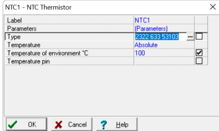
Facciamo variare la temperatura del termistore da 10 a 100C con passo 10C. Prendiamo nota della tensione in uscita.
