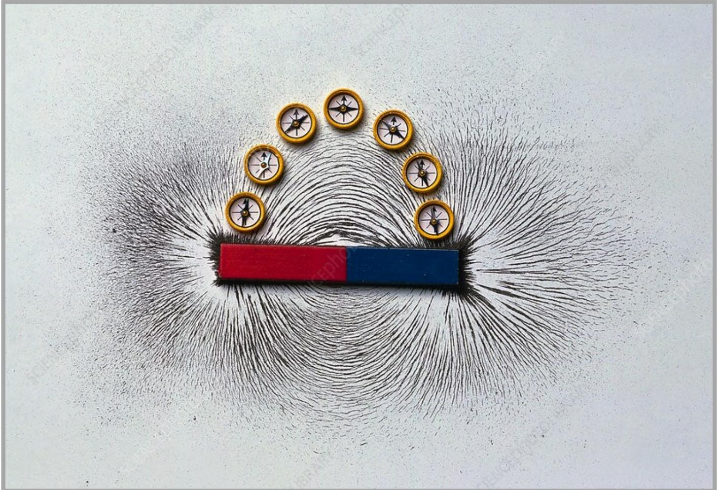
*La direzione delle linee danno la direzione del campo magnetico mentre lo spessore delle linee dà l'intensità del campo*
