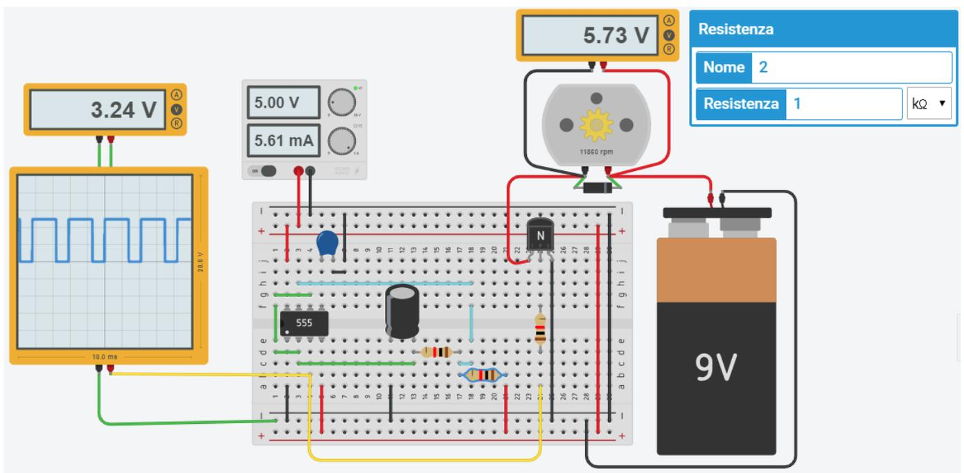
Variando il rapporto fra R1 e R2 varia la frequenza e il duty cycle (tempo in cui il segnale è alto rispetto al periodo) e di conseguenza il valore medio della tensioni di uscita dal timer che può essere usato per variare il numero di giri del motore in C.C ( tecnica chiamata PULSE WIDE MODULATION). Si ha una conversione del segnale da digitale ad analogico.
