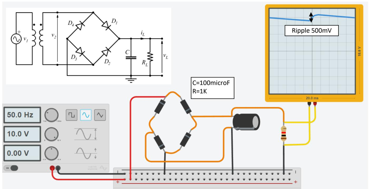
Le ondulazioni, in genere indicate col termine inglese "ripple", sono dovute alla corrente assorbita dal carico collegato all'uscita, e che, tra una semionda e l'altra, determina la fase di discesa (ovvero di scarica); all'arrivo della semionda che segue, il condensatore di livellamento torna a caricarsi, con una salita della tensione più o meno ripida (fase di carica).
