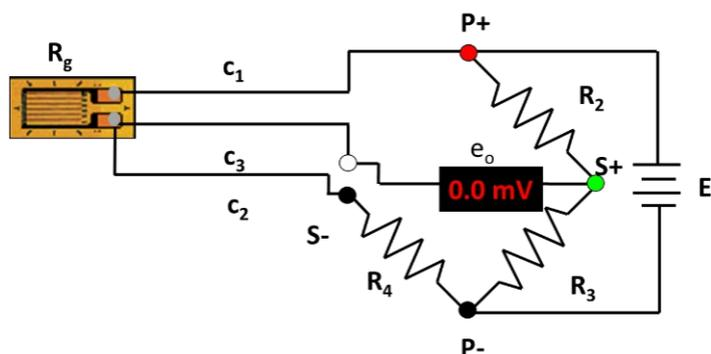
In questo caso sul ramo 1 del ponte insistono la resistenza  $R_g$  dell'estensimetro e la resistenza  $R_{c1}$  del cavo 1, mentre sul ramo 4 la resistenza  $R_4$  e la resistenza  $R_{c2}$  del cavo 2.
