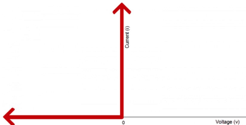
Qualsiasi tensione negativa produce corrente zero cioè il diodo si comporta come un interruttore aperto. Quando la tensione non è negativa il diodo si presenta come un interruttore chiuso.
