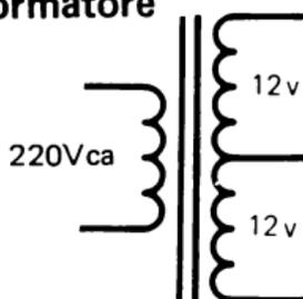
Un trasformatore può avere più di un secondario. Questo trasformatore ha un primario a 220 Vca e un secondario a 24Vca con presa centrale.
