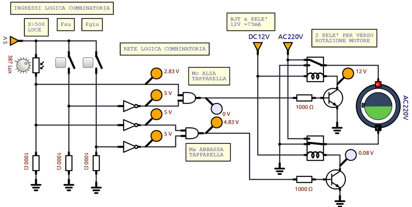
Il motore della tapparella assorbe 135W in tensione alternata AC 220V. Scegliere i relè e i transistor adatti.
