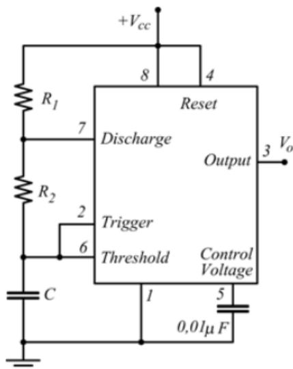
La tensione sul condensatore C oscilla tra  $1/3V_{CC}$  e  $2/3V_{CC}$  e l'uscita tra 0 e  $V_{CC}$ .
