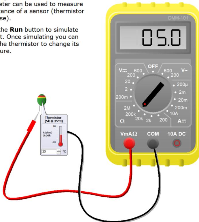
NB: le misure di resistenza vanno fatte sui componenti non alimentati (generatore spento).
