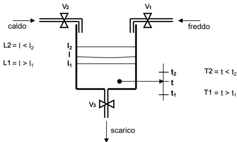
Si sintetizzi la rete combinatoria che realizza il sistema di controllo del livello e della temperatura.
