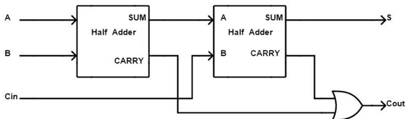
Sulla base delle due equazioni di cui sopra, il circuito sommatore completo può essere implementato utilizzando due mezzi sommatori e una porta OR. Di seguito è mostrata l'implementazione del sommatore completo utilizzando due mezzi sommatori.
