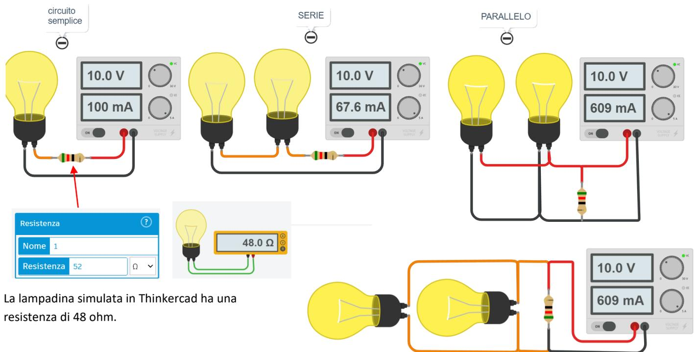
La lampadina simulata in Thinchercad ha una resistenza di 48 ohm.
