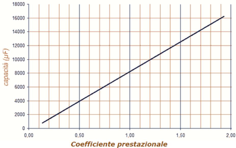
Equazione retta passante per 2 punti:  $(y-y_1)/(y_2-y_1) = (x-x_1) / (x_2-x_1) \rightarrow C = 8571,4 C_p - 285,71 \text{ [}\mu\text{F]}$
