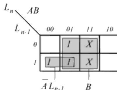
Abbiamo assunto, per comodità, come condizione di indifferenza i casi in cui vengano attivati i comandi A e B simultaneamente, se ne ricava la funzione :
