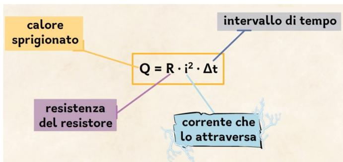
$Q = \text{Energia termica} = \text{Potenza Elettrica} \times \text{tempo}$  [Joule]
