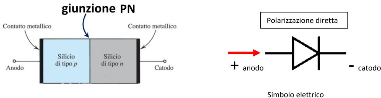
Un diodo si ottiene affiancando una regione di semiconduttore di tipo p (boro, alluminio, gallio o indio) con una di tipo n (arsenico e fosforo). La zona in cui le zone n e p si incontrano viene chiamata **giunzione p-n**.
