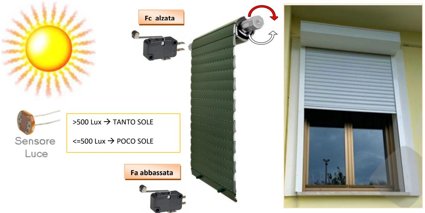
Il sistema impiega un sensore S per rilevare l'intensità luminosa e due finecorsa meccanici per sapere se la tapparella è ALZATA (Fc=1) o ABBASSATA (Fa=1).
