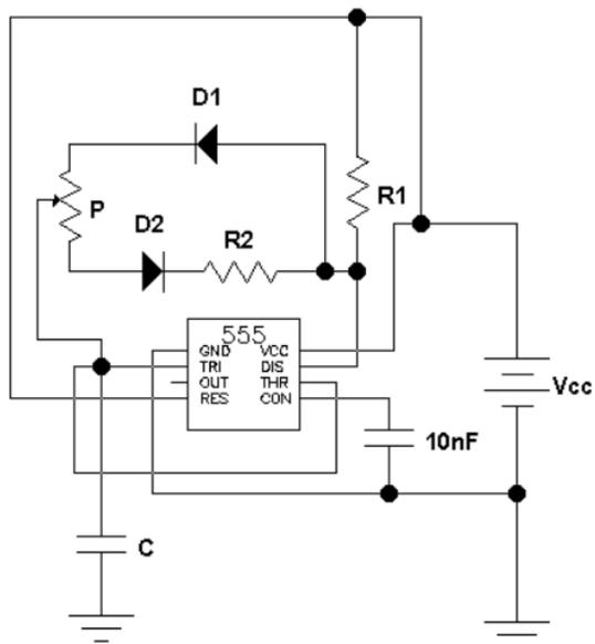
Il circuito genera un'onda quadra alla frequenza di 10kHz con duty cycle regolabile fra il 10-90%.
