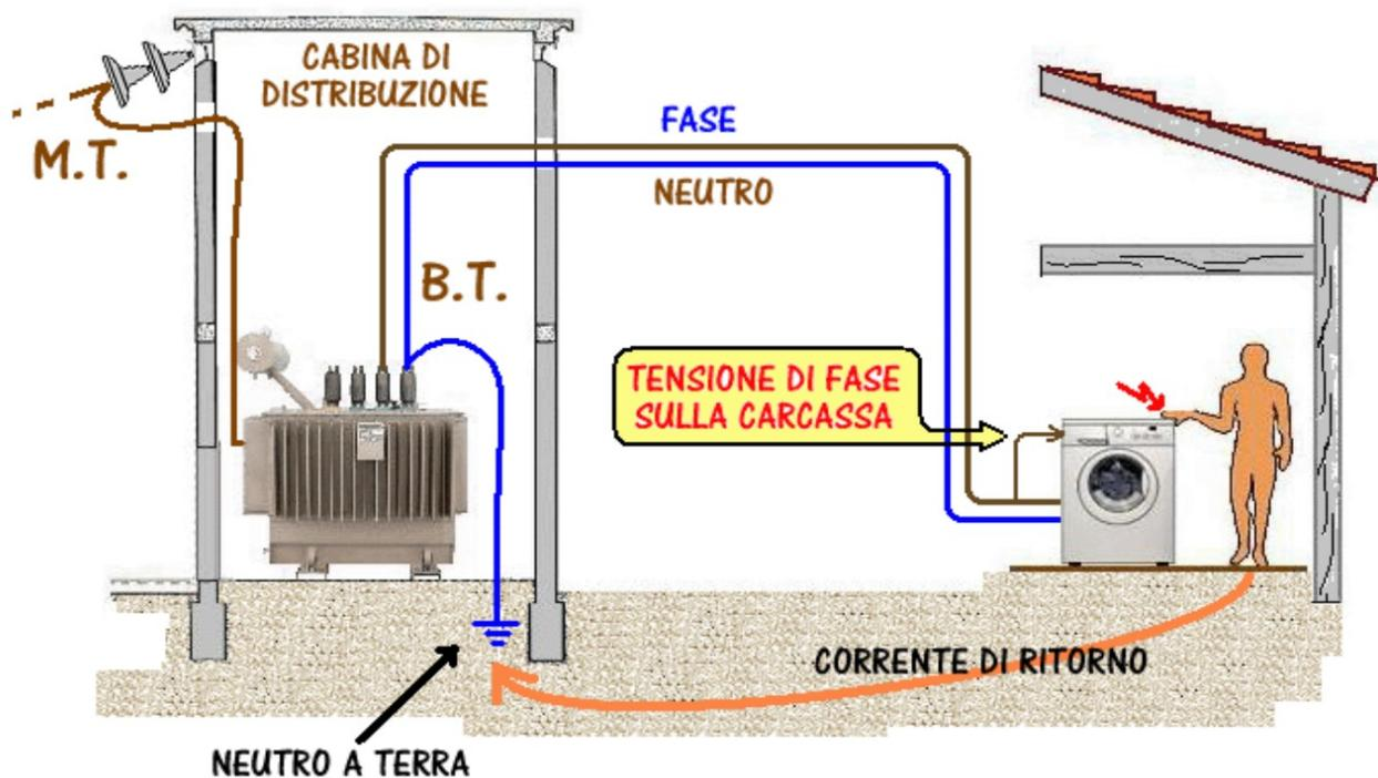
Se una persona accidentalmente tocca la carcassa della lavatrice, il suo corpo si trova a fare da circuito di ritorno: la corrente in arrivo, invece di rientrare al trasformatore percorrendo l'altro filo, attraversa il corpo dello sfortunato e ritorna alla cabina attraverso la terra; nella cabina di distribuzione, infatti, il neutro è collegato a terra.
