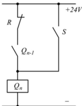
In elettrotecnica, questo circuito viene definito "autoritenuta ad attivazione prevalente" perché prevale il SET sul RESET.
