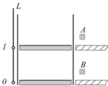
Un sistema di fotocellule è in grado di stabilire a quale piano si trova il montacarichi tramite la variabile di uscita  $L=1$ =piano alto,  $L=0$ =piano basso.
