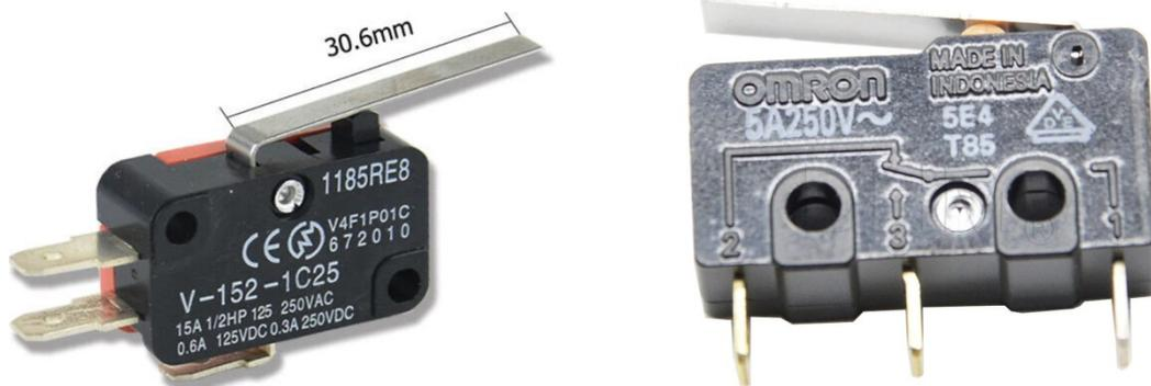
Vogliamo rilevare lo stato tramite un microcontrollore a 5V. Usiamo un partitore di tensione con corrente massima  $I=10\text{mA}$ .
