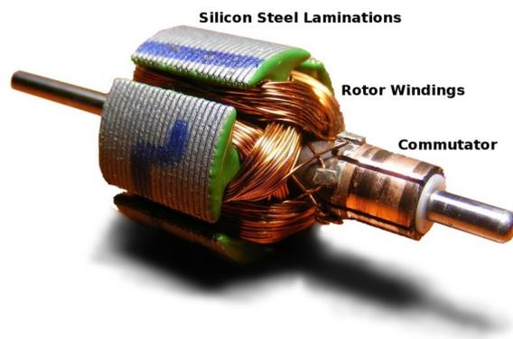
Le spazzole fisse forniscono energia elettrica al commutatore rotante.
