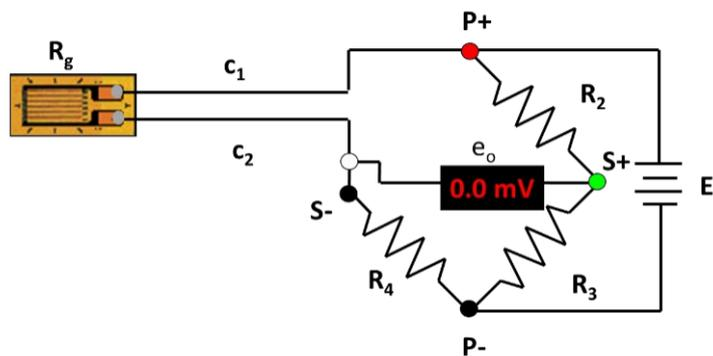
Come si può vedere essendo la resistenza  $R_g$  dell'estensimetro e le resistenze  $R_{c1}$  e  $R_{c2}$  dei due cavi tutte sullo stesso ramo del ponte ne risulta che il ponte è sempre sbilanciato in quanto non è verificata l'uguaglianza:
