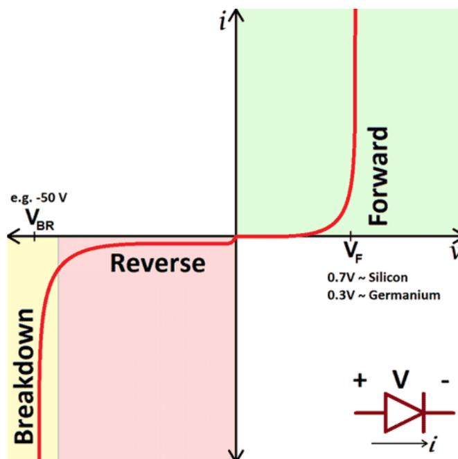
A seconda della tensione applicata attraverso di esso, un diodo opererà in una delle tre regioni:
