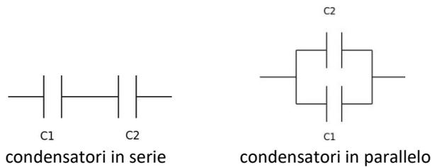
La capacità di un condensatore è il rapporto tra la carica accumulata  $Q$  e la sua differenza di potenziale e si misura in Farad (F):
