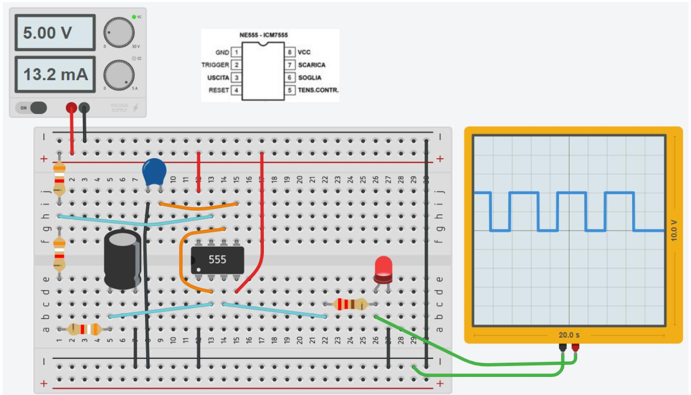
Nel circuito la R1 è costituita da due resistenze da 3.9K in serie per ottenere il valore desiderato di 7.8K.
