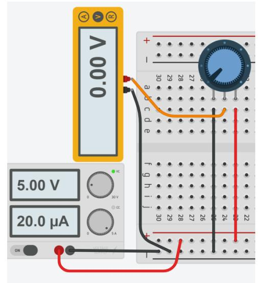
Il terminale centrale "2" è collegato allo slider. Nel disegno il terminale "1" è la Vcc ma si può scambiare col terminale "3" che è la massa. Il terminale centrale è sempre fisso e dovrebbe essere preso come output.
