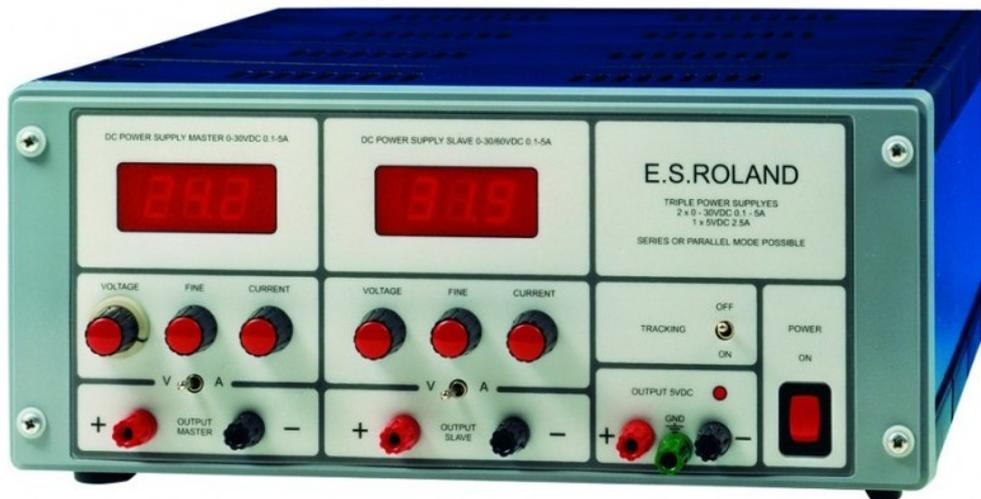
E' come se all'interno dell'alimentatore vi fossero due batterie collegate rispettivamente l'una alla coppia di boccole + e - di sinistra e l'altra alla coppia di boccole + e - di destra. La boccola con il simbolo di terra è isolata dalle due "batterie" ed è collegata al terzo polo della spina attraverso il terzo filo giallo/verde del cavo di alimentazione e quindi, se l'impianto di rete del laboratorio è ben fatto, quella boccola comunica con la terra.
