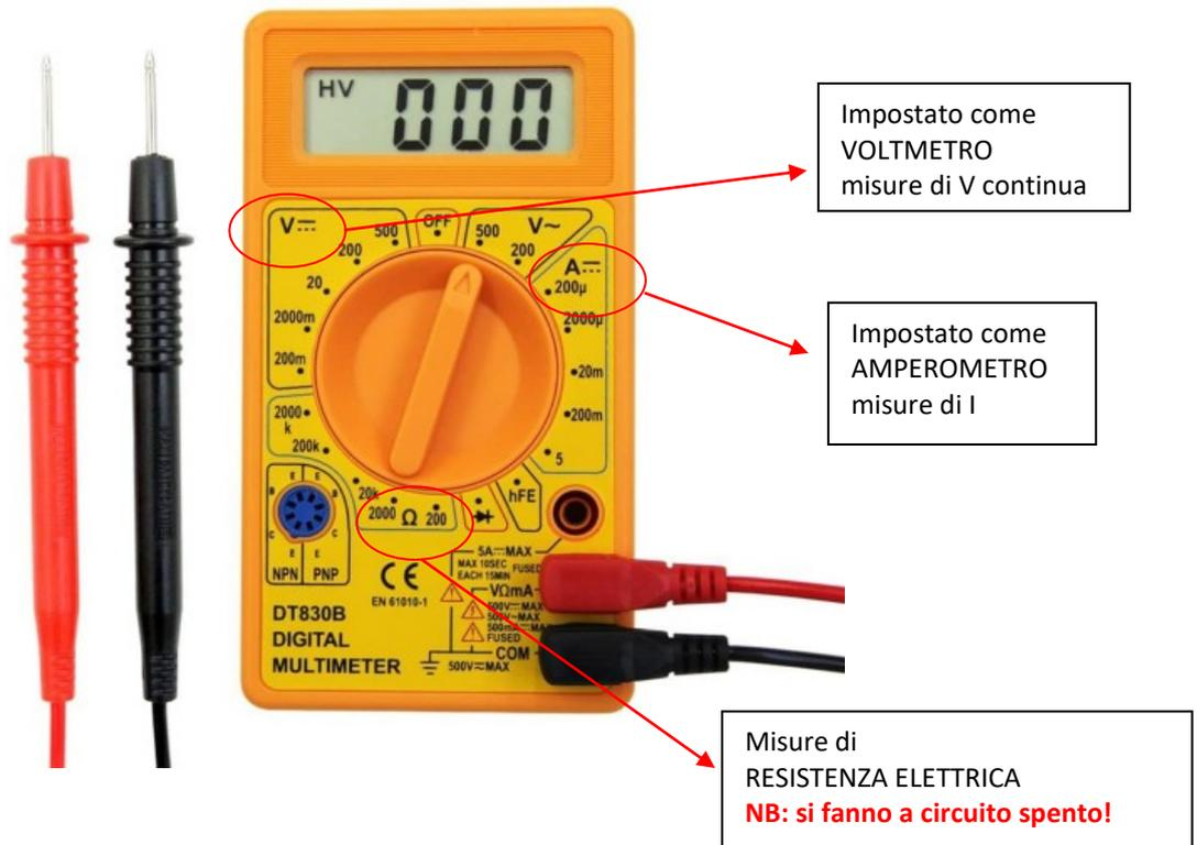
Esistono modelli avanzati "autorange" in cui non è necessario selezionare il fondo scale della misura.
