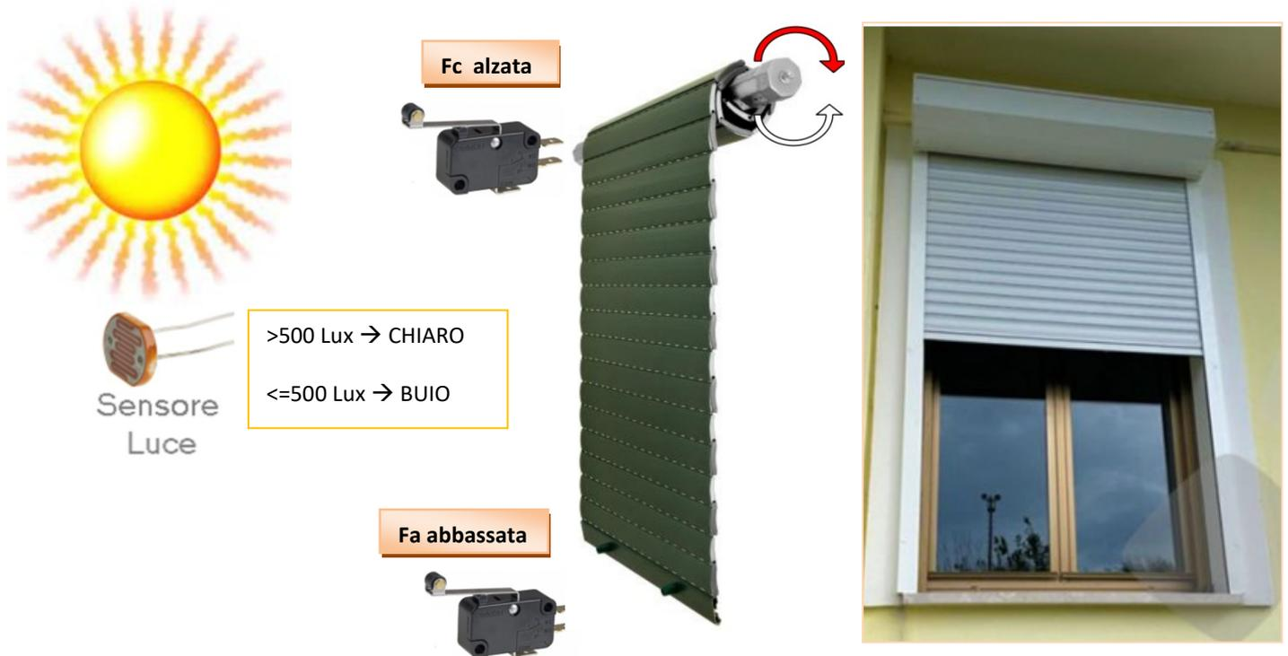
Il sistema impiega un sensore S per rilevare l'intensità luminosa e due finecorsa meccanici per sapere se la tapparella è ALZATA (Fsu=1) o ABBASSATA (Fgiu=1).
