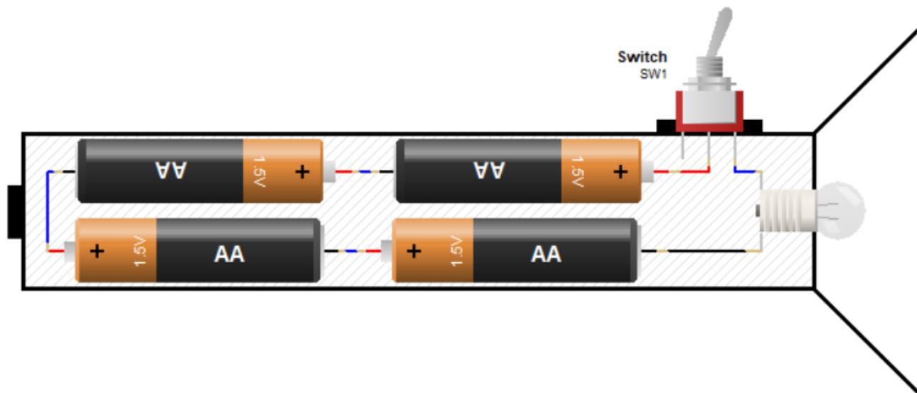
Quando la torcia viene accesa sia ha un leggero calo della tensione nominale delle batterie (che non sono generatori ideali di tensione). L'assorbimenti della lampadina è di 120 mA
