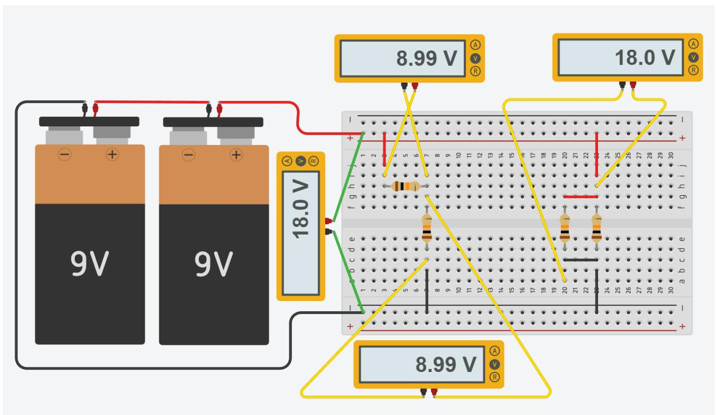
Le due batterie da 9V sono collegate in serie (il - della prima va a massa, il + della prima va nel - della seconda e dal + della seconda ottengo i 18 volt (9+9)).
