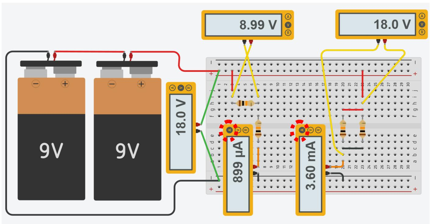
Le prime due resistenze da 10K sono in serie. La resistenza totale risulta la somma delle due.
