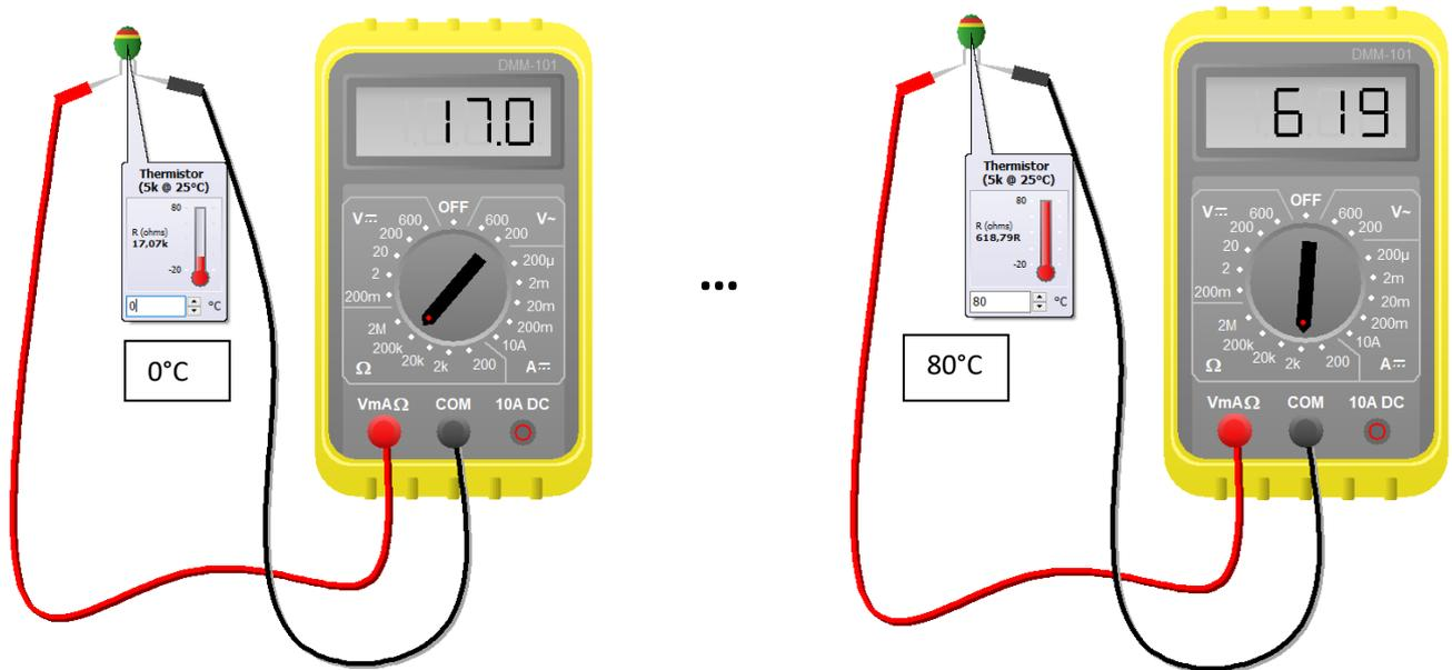
Si chiede di ricavare con EXCEL la curva caratteristica del termistore simulato nelle immagini soprastanti.
