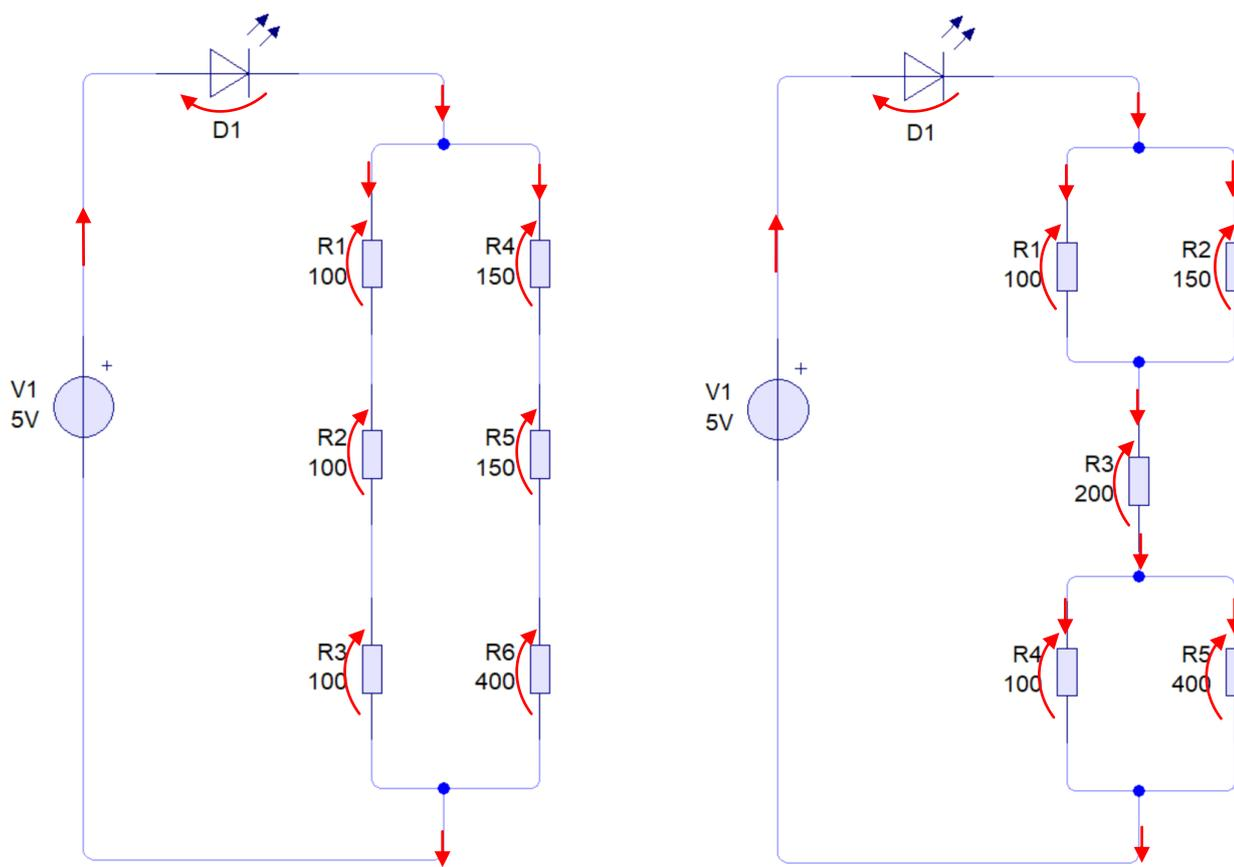
Ipotizzando di usare un powerbank da 2000mAh valutare per quanto tempo i diodi restano accesi nei due casi.
