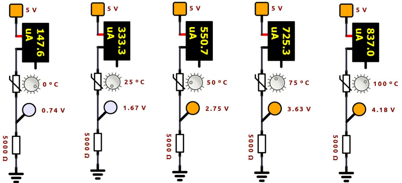
Ricavare la curva caratteristica  $V_{out}$ - $T$  del partitore di tensione di figura (termistore) nel campo di funzionamento 0-100°C.
