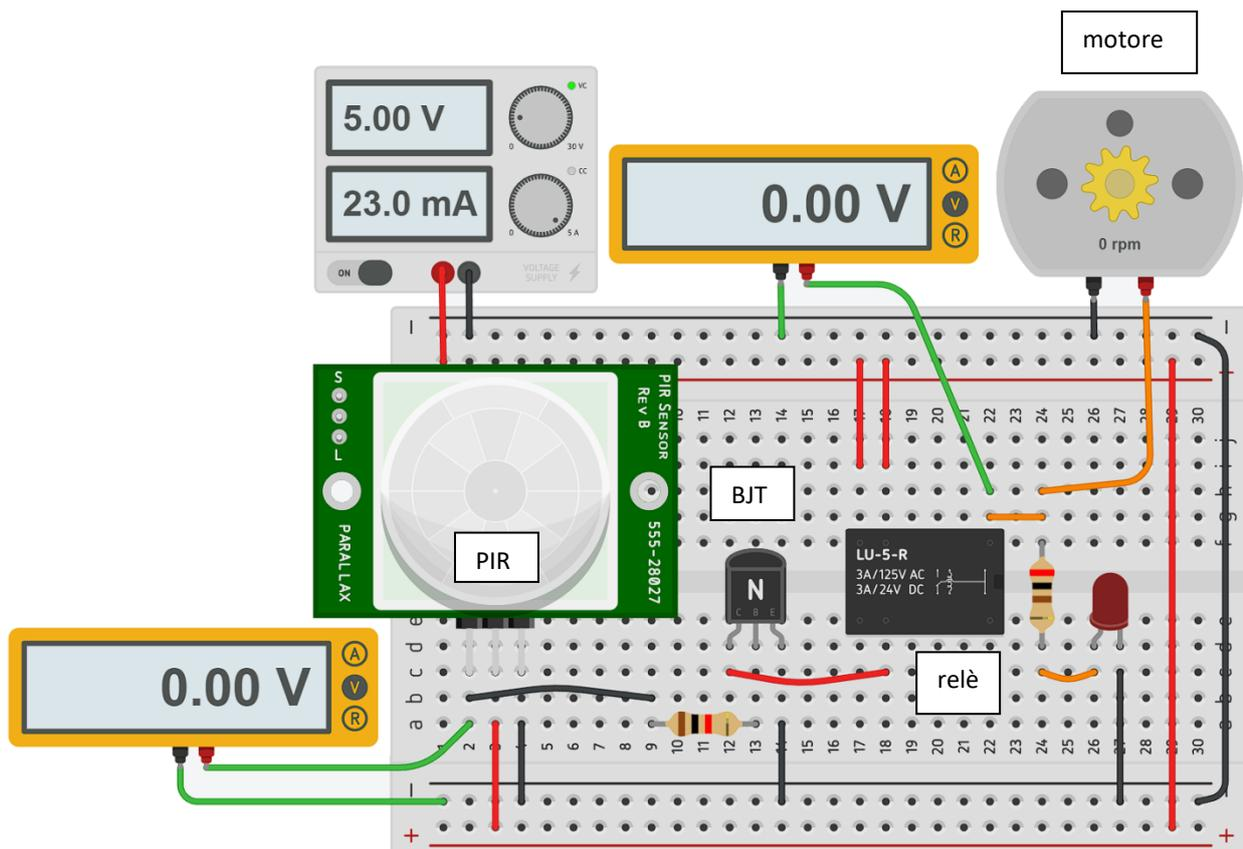
Il segnale in uscita al PIR (alto solo quando c'è movimento ...) non è sufficiente ad comandare direttamente un relè (sono necessari almeno 5V). A tal scopo viene inserito un transistor usato come interruttore di bassa potenza che serve ad attivare il relè quando il sensore PIR rileva presenza di persone nel suo raggio d'azione.
