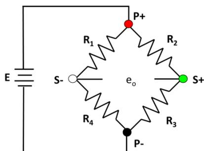
E = tensione di alimentazione del ponte,
