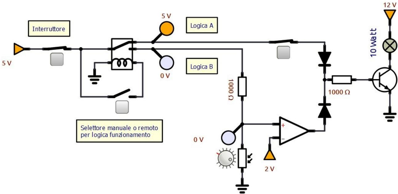
Attivazione verso di rotazione del motore CC con o senza un pulsante di sicurezza (da premere).
