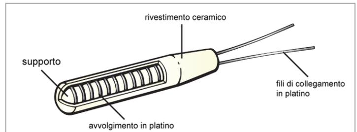
Normalmente i termometri a resistenza vengono identificati con la sigla del materiale utilizzato per la loro costruzione (Platino = Pt, Nichel = Ni) seguito dalla loro resistenza nominale alla temperatura di 0°C (esempio Pt100). Il campo di utilizzo dei termometri a resistenza industriali è compreso tra -200 e +850°C come riportato nella normativa EN 60751. Nel caso del platino la relazione tra resistenza e temperatura viene descritta dall'equazione di Callendar-Van Dusen (EN 60751)
