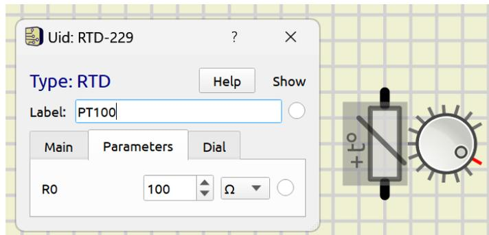
Facciamo variare la temperatura della RTD da 10 a 100C con passo 10C. Prendiamo nota della tensione in uscita.
