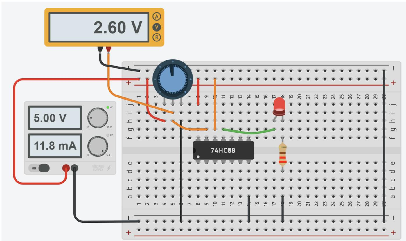
I test effettuati sulla porta logica a disposizione indicano una  $V_{ih}$  di circa 2.3V e una  $V_{il}$  di 1.8V.
