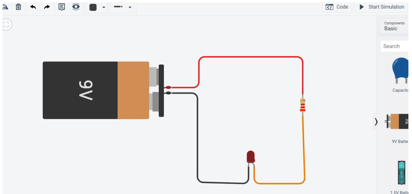
La simulazione viene eseguita mostrando l'accensione del LED e fornendo informazioni sul LED e sul carico elettrico posto sul LED (passare il cursore sul cerchio accanto al LED).
