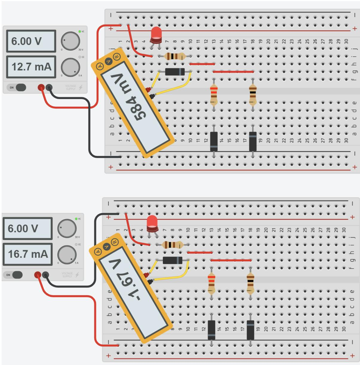
*NB: Con gli stessi componenti il diodo LED del 2° circuito si illumina maggiormente!*
