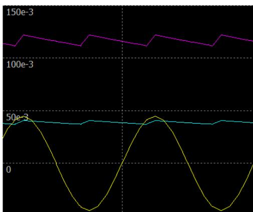
Se si abbassa la  $R_c$  a 100 ohm aumenta la corrente assorbita e di conseguenza anche il ripple (circa 1V).
