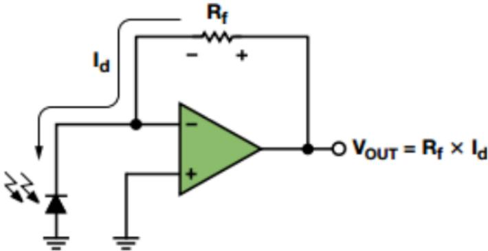
Questo circuito fa funzionare il fotodiodo in modalità fotovoltaica, dove l'amplificatore operazionale mantiene la tensione ai capi del fotodiodo a 0 V. È la configurazione più comune per applicazioni di precisione. La curva tensione/corrente del fotodiodo è molto simile a quella di un diodo normale, con l'eccezione che l'intera curva si sposterà verso l'alto o verso il basso al variare del livello di luce.
